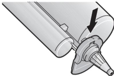
3. Zablokować kaniulę mieszającą przez zamknięcie zasuwę blokującą.
