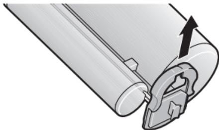
1. Aby otworzyć nabój, należy przesunąć zasuwę blokującą w górę. Nie należy zdejmować zasuwę blokującą z naboju.
