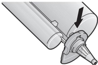
3. Mischkanüle durch Schließen des Verriegelungsschiebers arretieren.
