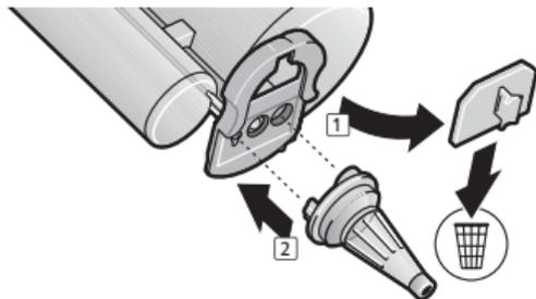
2. Den Verschluss von der Kartusche abziehen und verwerfen. Neue Mischkanüle aufsetzen.
