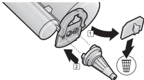
2. Снимите крышку-заглушку с картриджа и выбросьте её. Установите новый смесительный наконечник.
