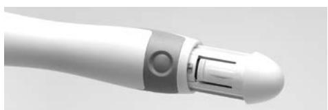
Не применяя усилие, вставьте наконечник в слот на зарядной базе. Если применяется гигиенический чехол, снимите его перед зарядкой аккумулятора. По возможности прибор постоянно используйте с полностью заряженным аккумулятором – это обеспечивает длительный срок службы. Поэтому рекомендуется после каждого пациента вставлять наконечник в зарядную базу. Зарядка полностью разряженного аккумулятора длится 2 часа.
