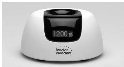
Oplaadstation met geïntegreerde radiometer en Click & Cure-functie (optioneel):
