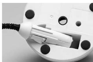
Güç kablosunu güç kaynağı ve güç paketine bağlayın. Güç kablosunun her zaman kolayca erişilebilir olduğundan ve güç beslemesinden kolayca bağlantısının kesilebildiğinden emin olun. Şarj tabanı ekranında kısa bir süre "Bluephase G4" metin olarak görüntülenir.
