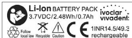
Należy zwrócić uwagę na to, że akumulatory litowo-polimerowe podczas ich używania niezgodnie z zaleceniami lub w wyniku uszkodzenia mechanicznego, mogą ulec eksplozji, zapaleniu lub mogą dymić. Uszkodzonych akumulatorów polimerowo-jonowych nie wolno używać.
