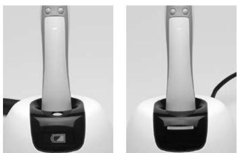
Aangezien de batterij een verslijtonderdeel is, dient deze te worden vervangen na afloop van de typische levenscyclus, na ongeveer 2,5 jaar. Zie het label van de batterij voor de leeftijd van de batterij.
