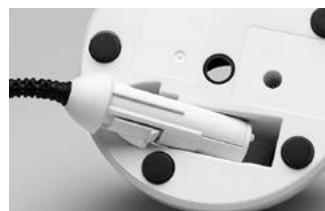
Podłącz kabel zasilacza do sieci i do zasilacza. Upewnij się, że kabel sieciowy jest łatwo dostępny i może być łatwo odłączony od sieci. Podstawa-ładowarka krótko pokaże napis "Bluephase G4" na wyświetlaczu.
