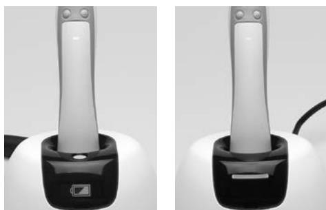
Eftersom batteriet är en förbrukningsvara, ska det bytas ut efter dess livscykel på ca 2,5 år. Läs på batteriets etikett för att se dess ålder.
