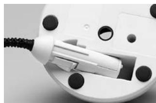
Koble strømkabelen til strømnettet og koble den til adapteren. Påse at strømkabelen til enhver tid er lett tilgjengelig og enkelt kan trekkes ut av stikkontakten. Ladestasjonen viser kort «Bluephase G4» på displayet.
