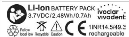
Σημειώστε ότι οι μπαταρίες λιθίου-πολυμερούς αντιδρούν με έκρηξη, φωτιά και καπνό αν τις χειρίζεστε ακατάλληλα ή έχουν υποστεί μηχανική ζημιά. Οι κατεστραμμένες μπαταρίες λιθίου-πολυμερούς δεν πρέπει να χρησιμοποιούνται πια.
